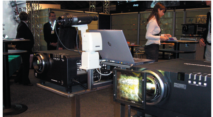
Aufbau mit Farbfilter zur Simulation von Alterungseffekten
